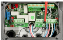
III. 23: Connexion des câbles d'alimentation de moteur
